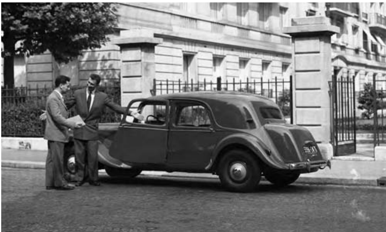
« 11 Normale », 1954. La nouvelle malle arrière englobant la roue de secours est adoptée sur les Traction Avant le 15 juillet 1952.
