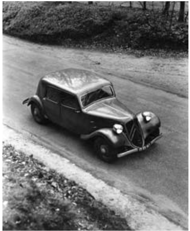
« 11 A », 1936. Avec 620 455 exemplaires produits de 1934 à 1957, la « 11 » est le modèle le plus répandu. Jusqu'en juin 1937, elles reçoivent des avertisseurs placés dans les ailes avant. Ensuite, ils sont placés derrière la calandre.
