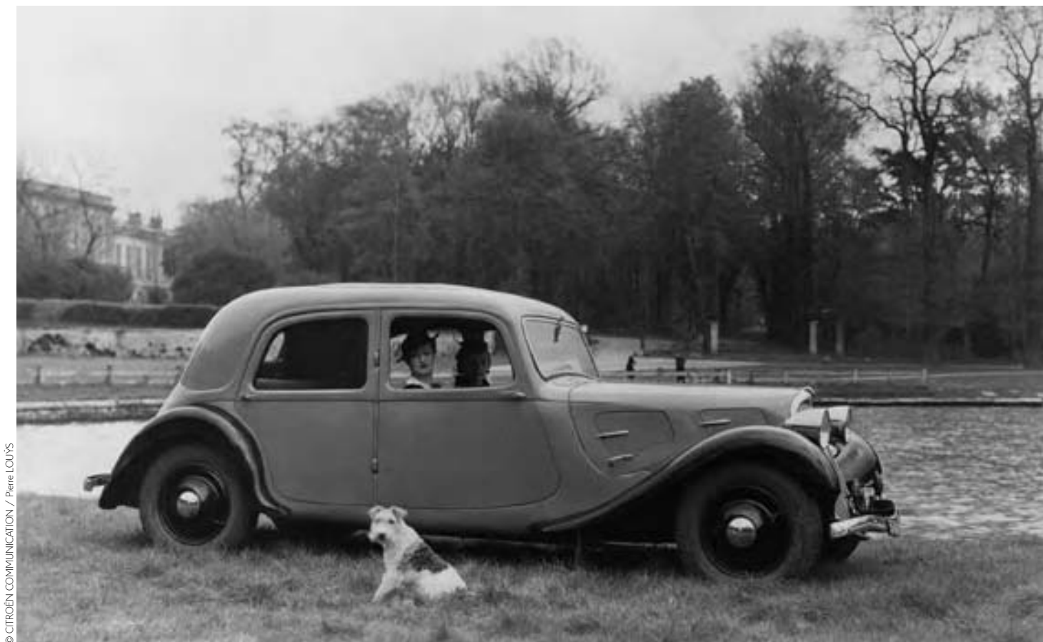
Un des prototypes de la « 7 A » photographié au cours de l'hiver 1934 dans le parc du château de Versailles. Le galbe de l'aile arrière n'est pas encore définitif et il est équipé d'un essuie-glace unique, d'avertisseurs peints et de grosses poignées de volets de capot.
